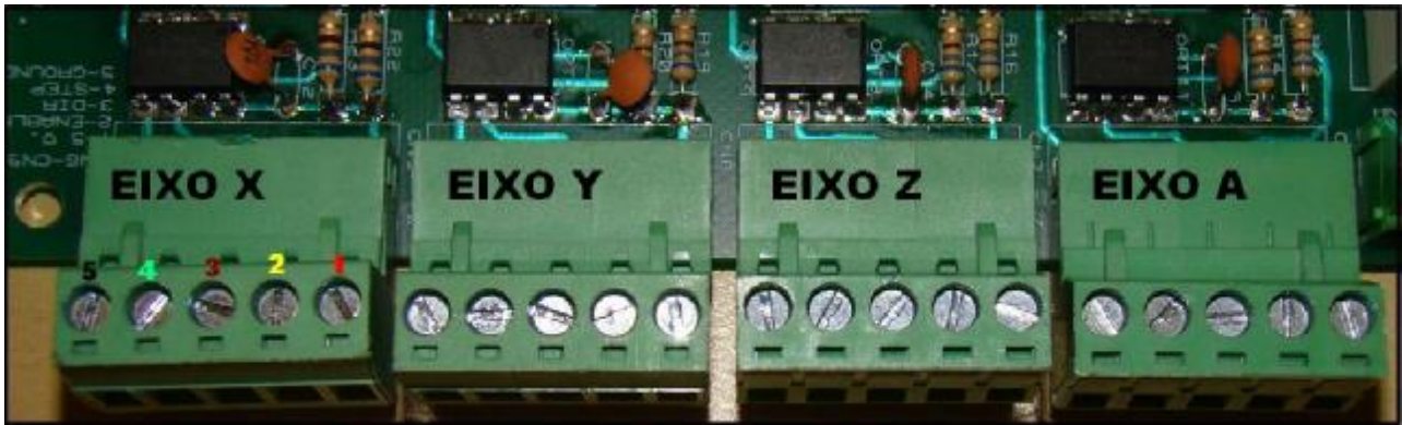
Figura 2 - Conectores dos drivers.
