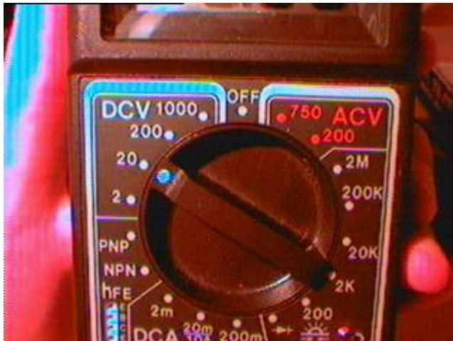
Para medir a voltagem de uma fonte de corrente contínua (pilha, bateria) coloque o seletor em DCV, encoste a agulha vermelha no pólo positivo.
