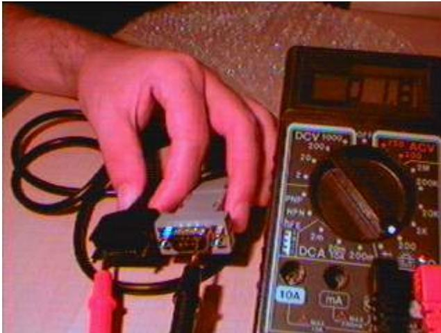
Para medir a continuidade de um cabo coloque a agulha de um lado e do outro do cabo, nos pinos que deveriam estar ligados um ao outro pelo cabo (portanto em curto) se a luz acender significa que a continuidade do cabo está garantida (ele não está rompido).
